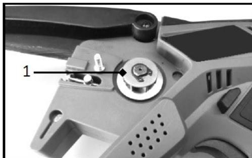
1. Wałek zębaty; 2. Elementy sprawdzone pod kątem zużycia
